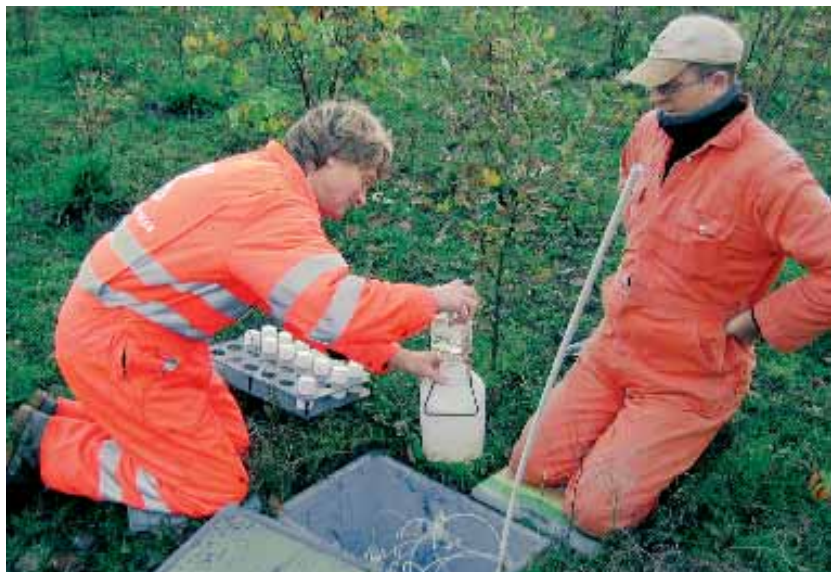
Udtagning af jordvandsprøver ved et af Skov & Landskabs forsøg. Jordvandsprøven suges ud af jorden ved hjælp af en porøs 'sugekop' og et fast undertryk. Foto: Claus Jerram Christensen.
