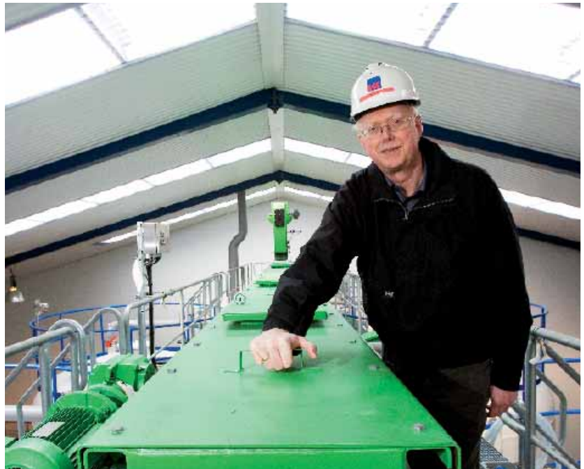
Teknisk chef hos Kommunekemi, Ole Kristensen, beskriver halmbehandlingsanlægget som en stor vaskemaskine, der udvinder gødningsstoffer ved at vaske halmflyveasken med vand. Foto: Alex Tran.
