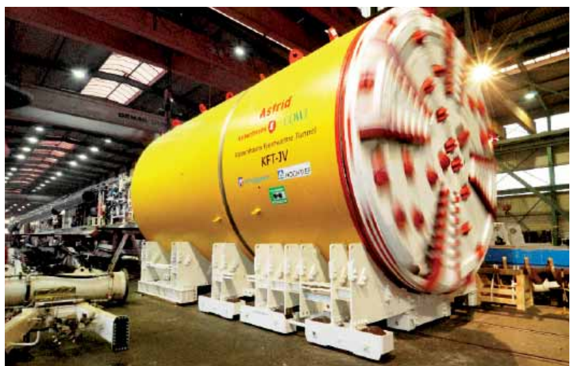
Boremaskinen "Astrid", der er opkaldt efter Københavns Energis varmechef, Astrid Birnbaum, er hele 128 meter lang. Den ankommer efter planen til Danmark midt i juni, hvorefter den skal bore cirka 15-20 meter tunnel om dagen. Foto: Henrik Pyndt Sørensen.
