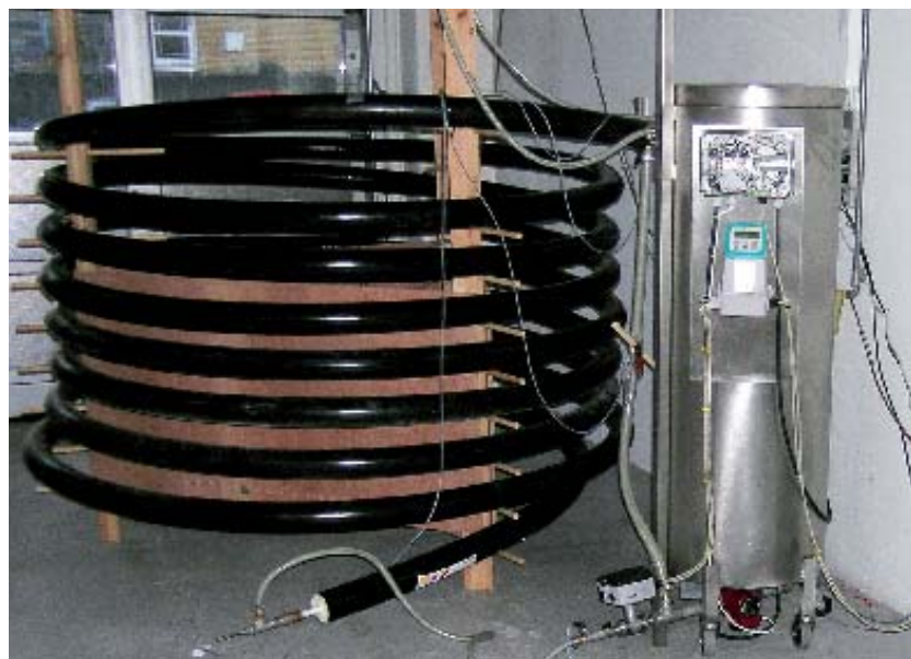
Som en nyhed har Teknologisk Institut udviklet en prøvestand, der gør det muligt at teste fleksible rør. Med den nye prøvestand kan rørene testes uafhængigt af medierørets dimension og materiale. Foto: Teknologisk Institut.
