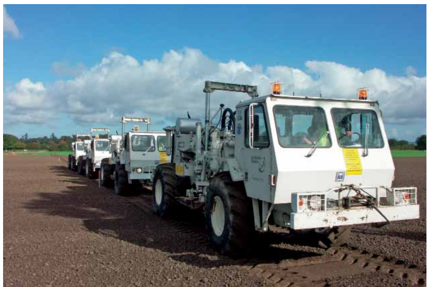
De specielle køretøjer, der laver seismiske undersøgelser af undergrunden forud for en geotermisk boring, kan få nok at se til i Danmark i de kommende år. Interessen for geotermi som energikilde er i hvert fald fortsat stor hos varmeværkerne. Foto: Flemming L. Rasmussen.
