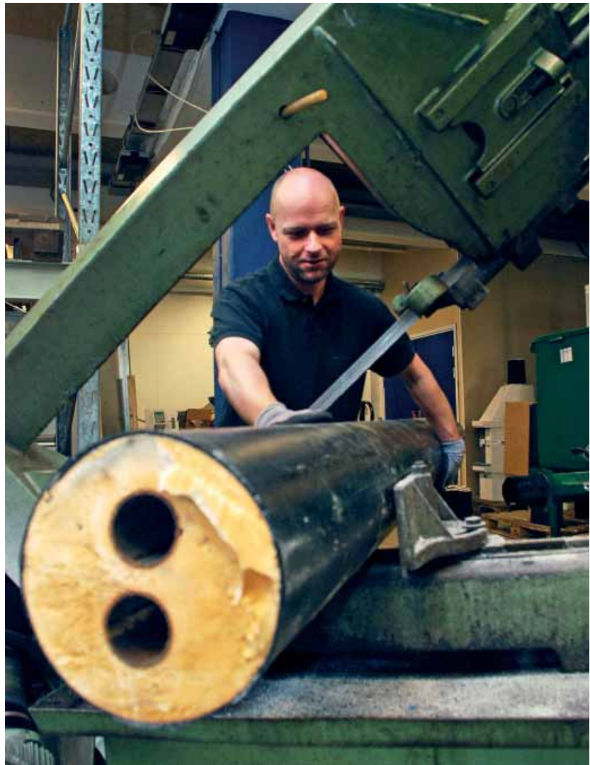
Niels Winther, Teknologisk Institut, er i gang med årets test af fjernvarmerør. Her er han ved at skære mindre stykker ud, som skal bruges til cellegasanalyse. Foto: Flemming L. Rasmussen.
