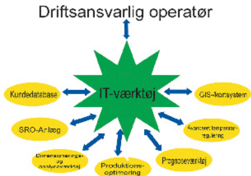
Figurtekst: IT-værktøjet har til funktion at integrere andre programsystemer, samt skabe en brugervenlig oversigt for operatøren.
