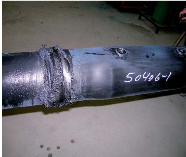
Billedet viser enden af en krympemuffe, som ikke kunne modstå sandbox-prøven, der er en af de prøvninger, som Teknologisk Institut tilbyder for præisolerede fjernvarmerør.
